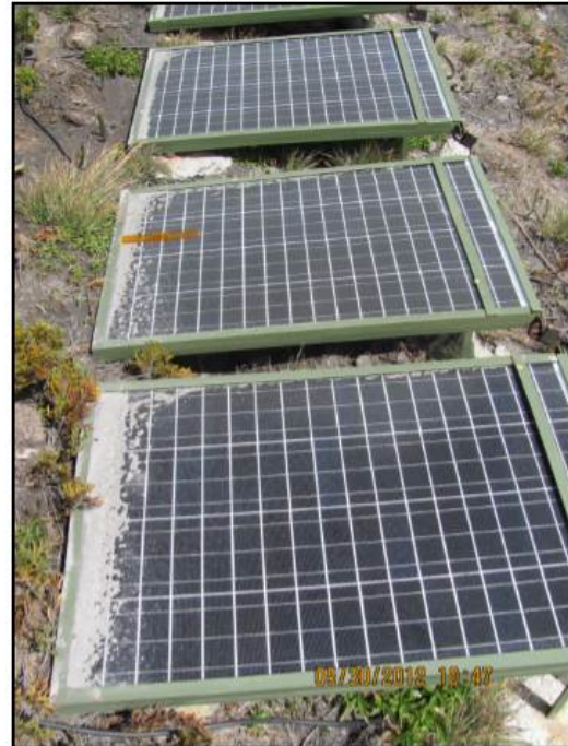
Figura 2.1.6.7. Paneles solares de la Estacion de Barranco Alto, en los cuales se observa material particulado, asociado a las emisiones del 26 y 27 de mayo.
