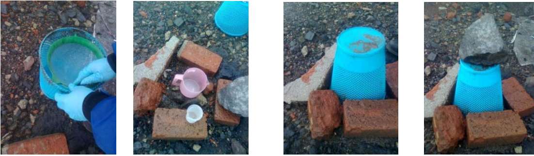
Figura 2.1.4.6. Fotografías de la instalación de una trampa alcalina en la cima del volcán Galeras. Fecha de muestreo: 14 de marzo de 2012
