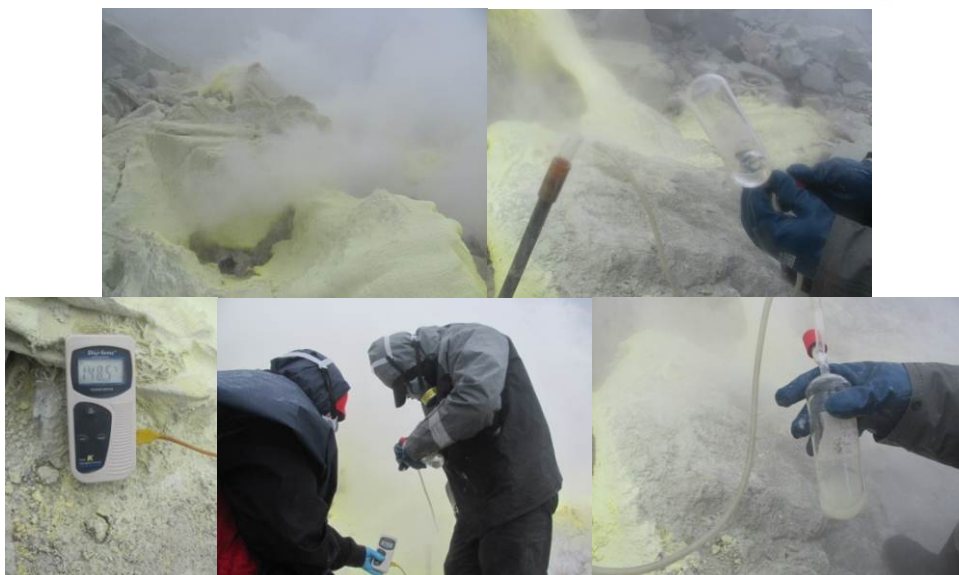
Figura 2.2.4.2. Fotografías de la toma de muestra de gases en la Fumarola El Rastrojo y el Verde del Volcán Cumbal.
