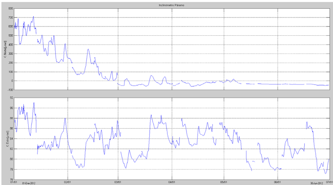
Figura 2.3.3.2. Componentes Norte y Este del inclinómetro Páramo, para el periodo comprendido entre el 1 de enero y el 30 de junio de 2012.
